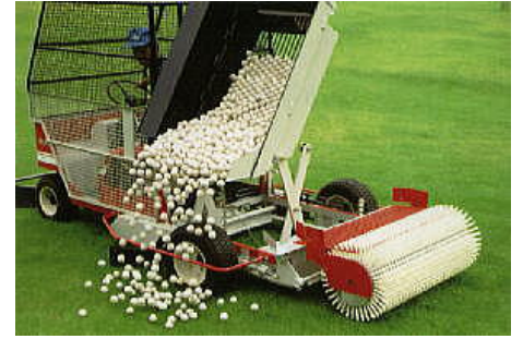
③車体左側方へダンプ排出
